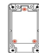
Instalación óptima utilizando los tres tornillos.
