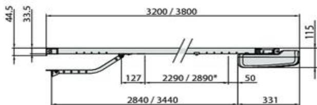
\* corsa utile / usable travel / course utile / nutzhub / carrera útil / werkslag
